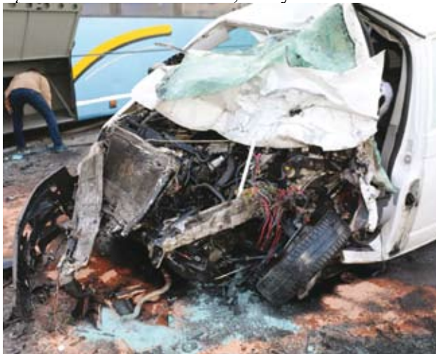
Ryc. 3. - Widok przedniej części nadwozia pojazdu uszkodzonego w wyniku zderzenia czołowego z autobusem na prostym odcinku drogi. Podczas wyko-
